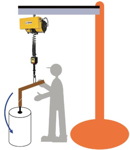
治具をダイレクトに動かして位置合わせをして挿入できる。機械の操作も不要。
