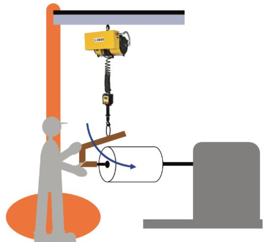
治具を手で直接微細に位置調整することができる。
