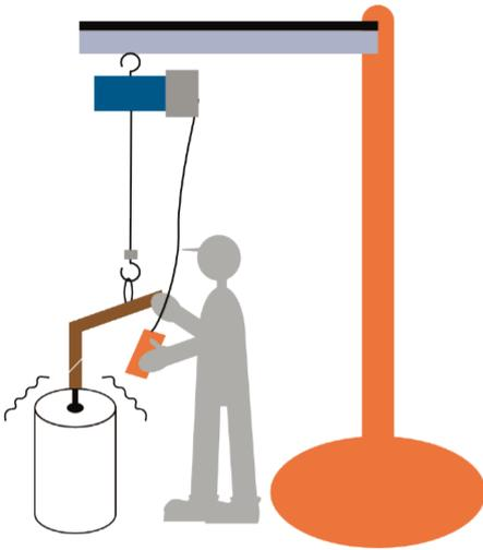
治具を押しボタンで微調整しながら治具をワークに挿入する。
