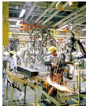
自動車工場で溶接機を吊るスプリングバランサー
