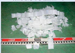
短冊状に破碎されます (減容率 約35%)
