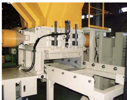
粒度調節装置を装着した状態
