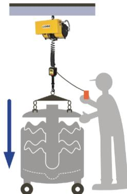
攪拌機に手で触れて位置調整ができ、操作も簡単。慣れない作業者でも1人で作業できる。
